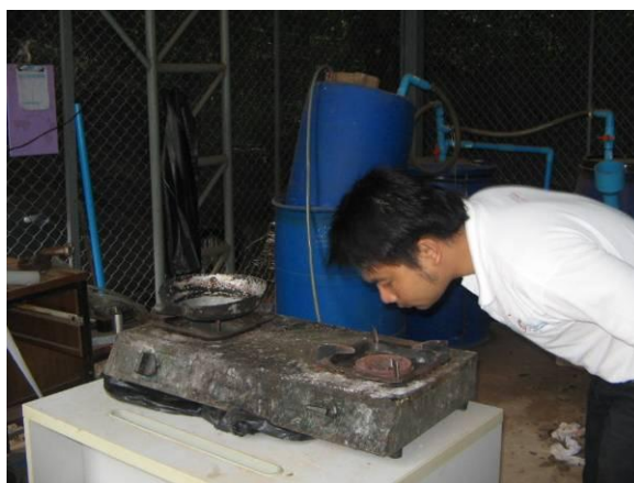
รูปที่ 15 การตรวจเช็คก๊าซ โดยการดมกลิ่น ก่อนที่จะจุดไฟ
