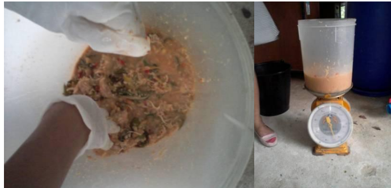
รูปที่ 6 แสดงการชั่งเศษอาหารที่ผสมกับน้ำก่อนเติมลงในถังผลิตกรด
