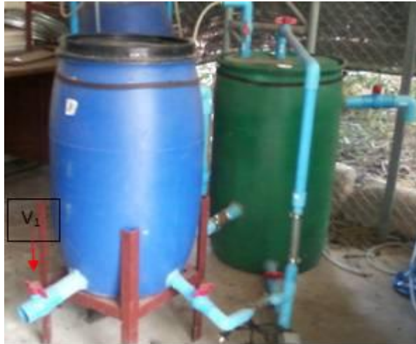
รูปที่ 14 แสดงตำแหน่งของวาล์วเพื่อใช้ในการระบายตะกอนของถังผลิตกรด
