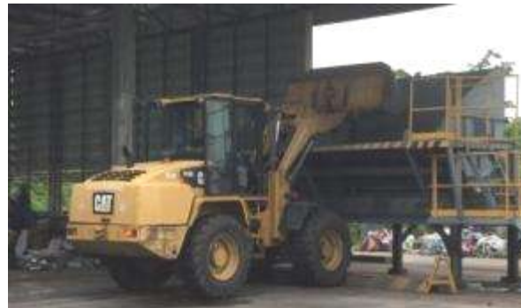
2. จุดรับขยะและตักเข้าระบบสายพาน
